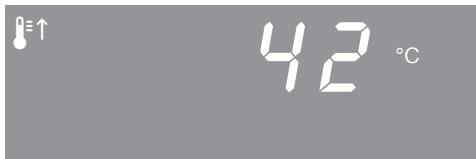
Вы можете следить за подъемом температуры. При первом достижении выбранной температуры раздается сигнал, если он включен (см. главу "Установки - Р 2").
