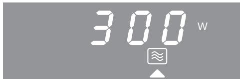
Могут быть выбраны следующие значения мощности: 80 Вт, 150 Вт и 300 Вт.
