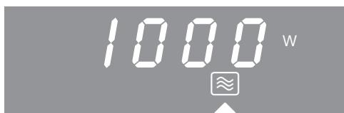
Следующие значения мощности СВЧ можно выбрать: 80 Вт, 150 Вт, 300 Вт, 450 Вт, 600 Вт, 850 Вт и 1000 Вт.
